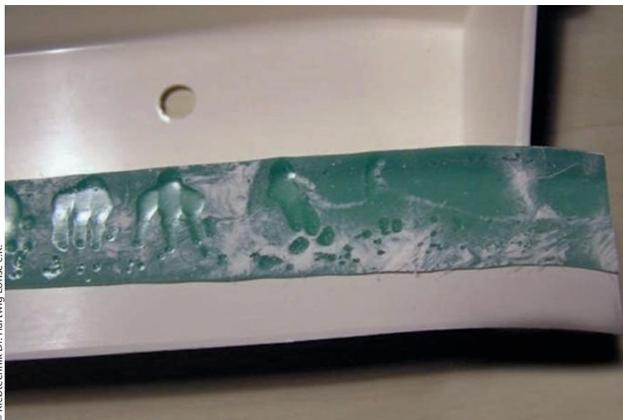
**Bild 1** > Fehlerhafte Klebung eines FVK-Bauteils aufgrund nicht vollständig vernetzter Polyestermatrix. Bei der wärmeunterstützten Klebstoffhärtung wurden Restmonomere freigesetzt, die zu dem adhäsiven Fehlerbild mit Blasen an der Grenzschicht führten.
