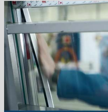
Montage des pare closes
