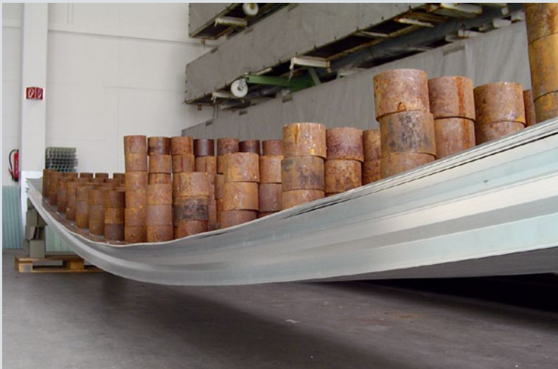
Bild 10: Belastungsprobe an einem realen Fassadenelement (Bild: Butzbach GmbH)
