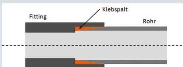
Bild 7: Rohrverklebung mit keilförmigem Klebspalt
