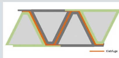
Bild 4: Das Fiberline AS Brückendeck, links: schematische Darstellung, unten v.l.n.r.:
