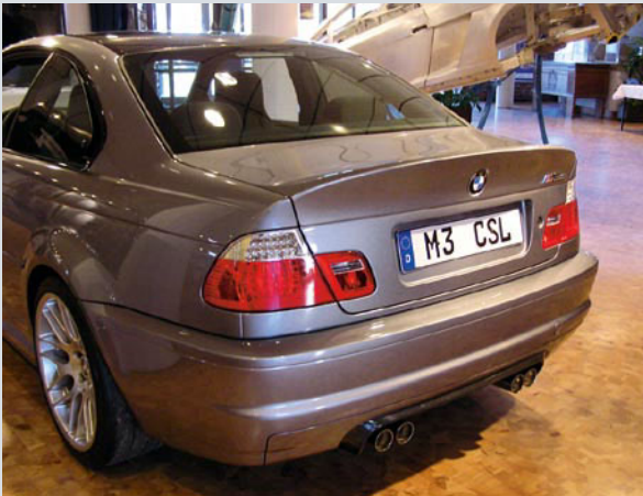
Bild 4: Der Kofferraumdeckel des BMW M3 CSL, bestehend aus zwei miteinander verklebten SMC-Kunststoffteilen
