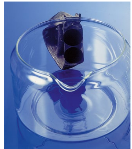
Bild 3 > Geklebte Kaffeekanne nach Kochtest bei 140 °C / 3 bar
