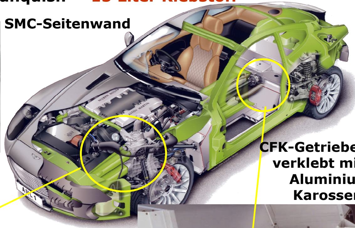
CFK-Aggregateträger verklebt mit der Aluminium-Karosserie
