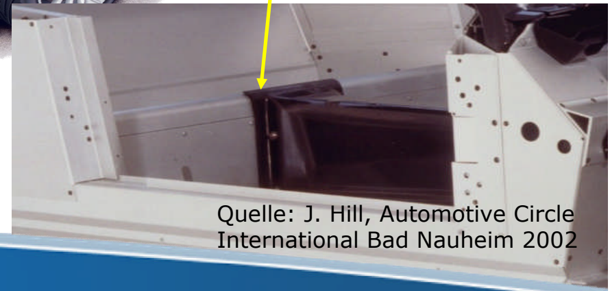
CFK-Getriebetunnel verklebt mit der Aluminium- Karosserie
